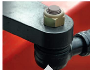
Cabezal de barras de acoplamiento ajustables
