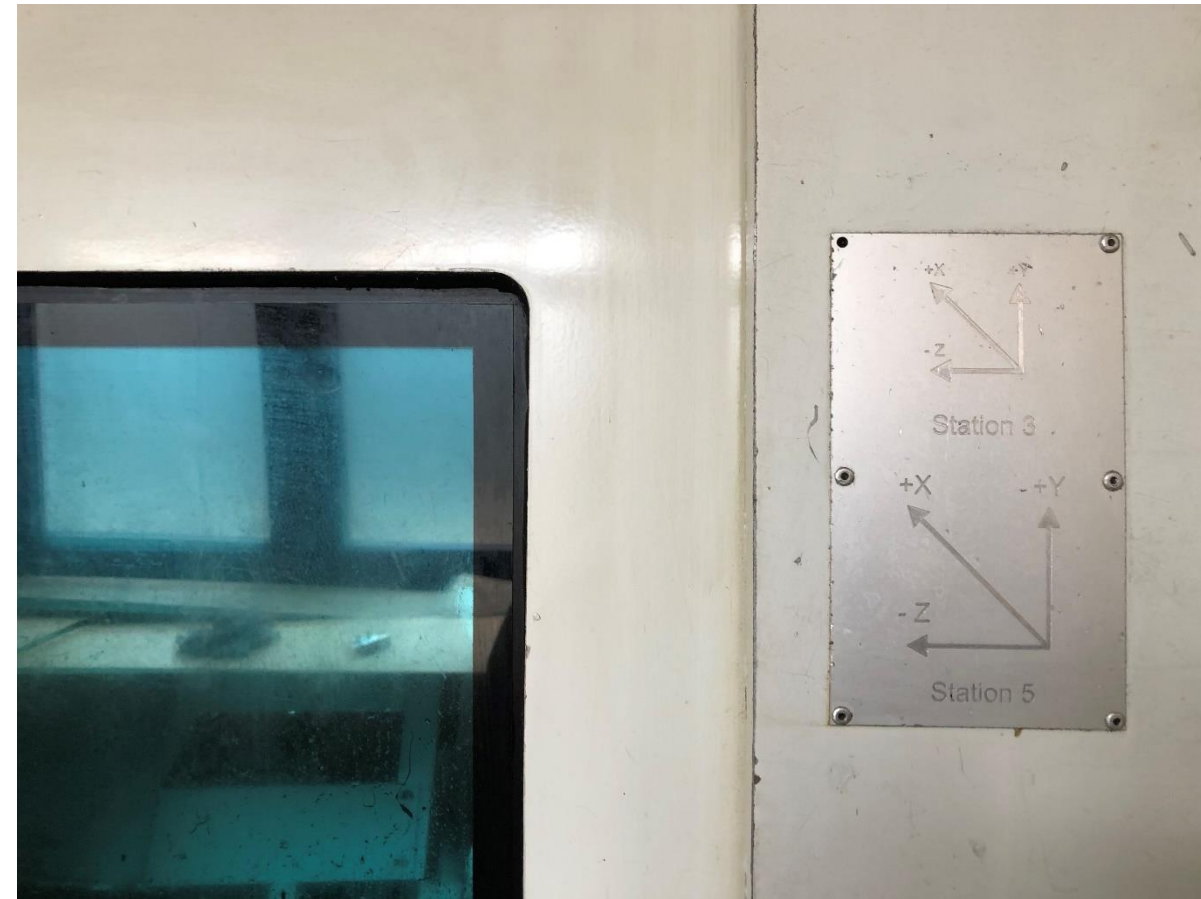
ESTACIÓN 3: FRONTAL LH (puerta carga con robot) ESTACIÓN 5: POSTERIOR RH (puerta revólveres)
