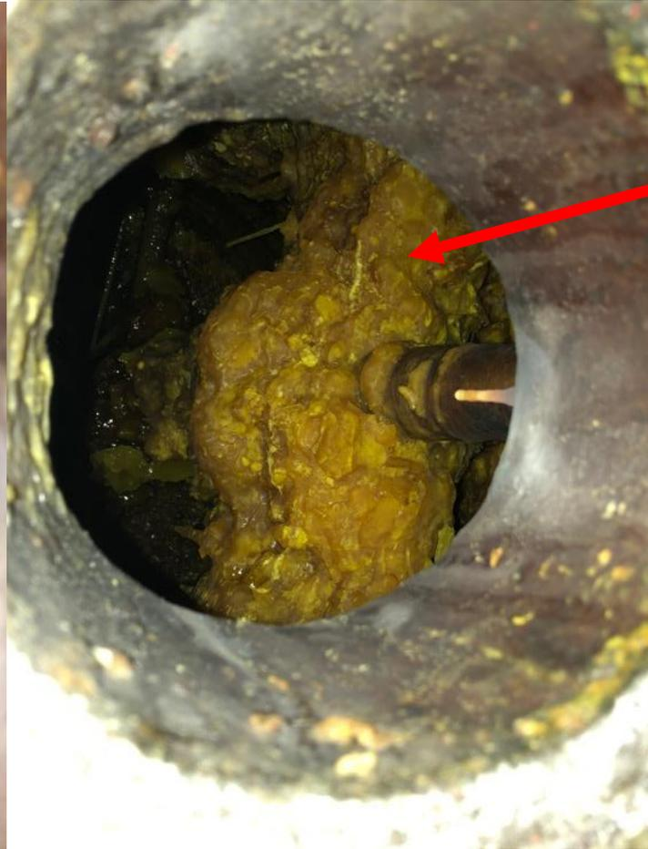
Der Isocyanatbehälter ist unbrauchbar, da auskristallisiert. Die Rohrleitung und das Schlauchpaket zum Mischkopf ist zukristallisiert.
